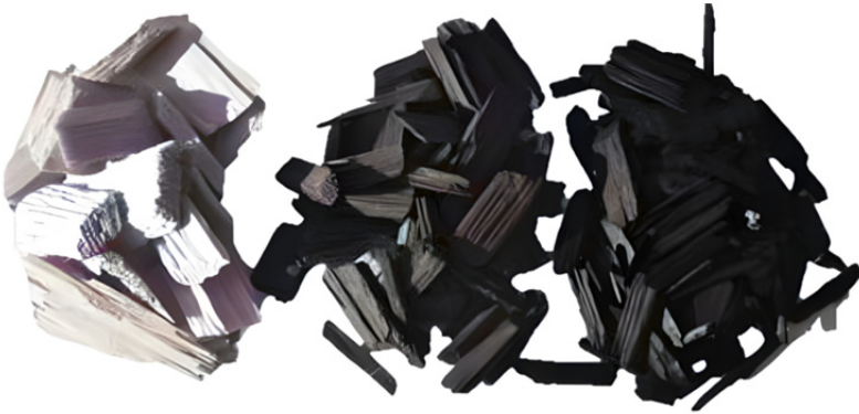
Şekil 4.1: Orijinal odun parçası (solda), 260 °C’de 8 dakika (ortada) ve 285 °C’de 16,5 dakika torrefaksiyon işlemi görmüş odun parçası (sağda)
